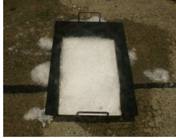
低発泡ノズルでの泡シーリングの状況
