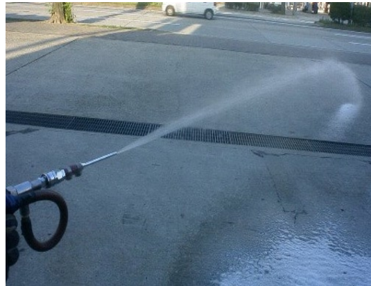
ピンポイントノズル (ノズル口径3mm) ※放水量 薬液混合5ℓ/分 射程約5m
