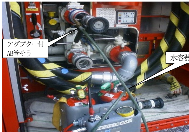
アダプター付AB管そうによるタンク給水の状況
