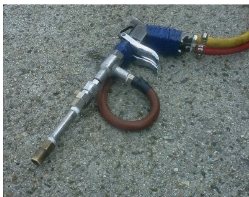
ミストノズル (水粒子約100~150ミクロン) ※ 放水量 水+空気6ℓ /分 射程約3m
