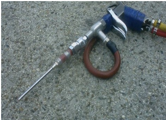
ピンポイントノズル (ノズル口径3mm) ※放水量 薬液混合5ℓ/分 射程約5m
