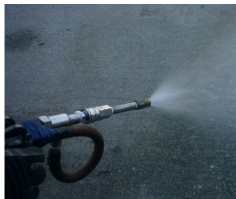
ミストノズル (水粒子約100~150ミクロン) ※ 放水量 水+空気6ℓ /分 射程約3m
