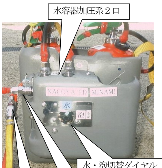
低発泡ノズル 写真は縦方向放水状態 ※放水量 10ℓ/分 射程約2m ※泡放水形状は扇状であり縦・横方向が選択可能
