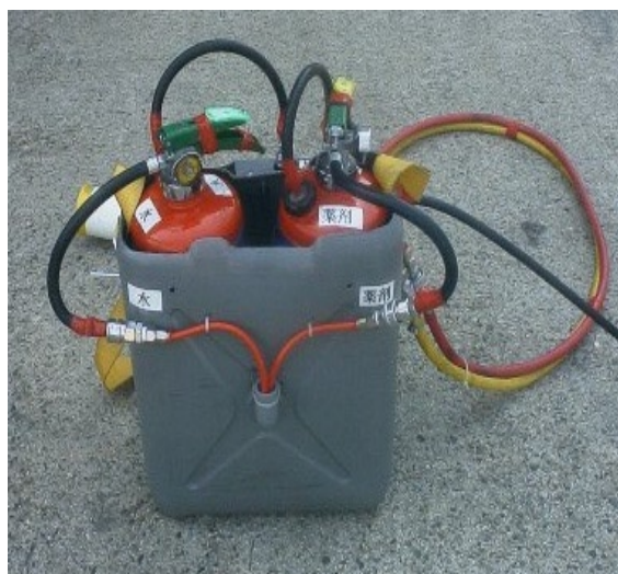
低発泡ノズル 写真は縦方向放水状態 ※放水量 10ℓ/分 射程約2m ※泡放水形状は扇状であり縦・横方向が選択可能
