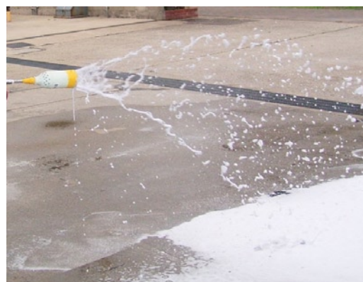
低発泡ノズル 写真は縦方向放水状態 ※放水量 10ℓ/分 射程約2m ※泡放水形状は扇状であり縦・横方向が選択可能
