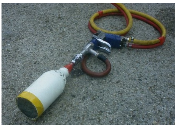
低発泡ノズル 写真は縦方向放水状態 ※放水量 10ℓ/分 射程約2m ※泡放水形状は扇状であり縦・横方向が選択可能
