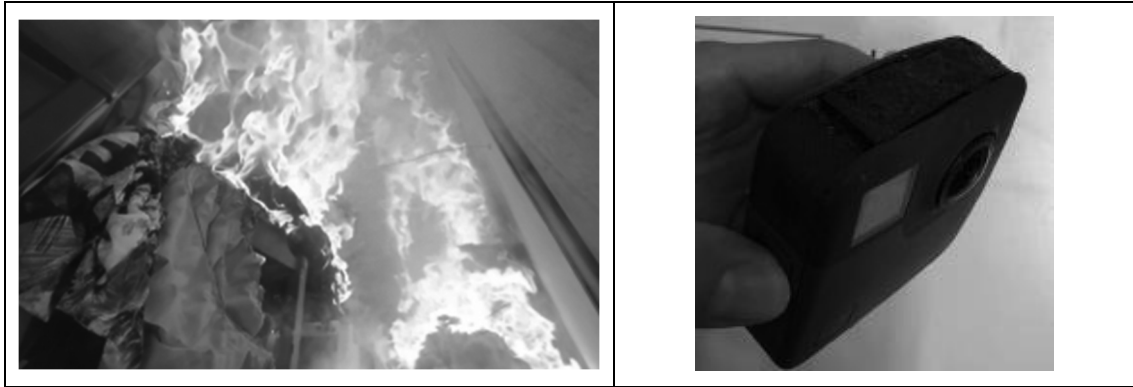
写真2 上部を焼損した360度カメラ (VR映像業者所有)
