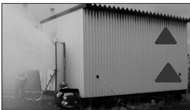
図14 検証3 状況図③(▲の箇所内部の温度を計測)
