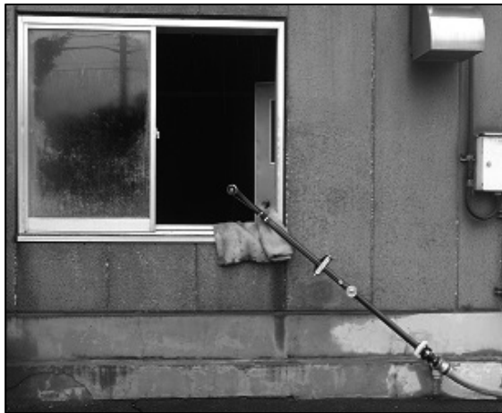
図8 開口部Xに設定した水力換気ノズル
