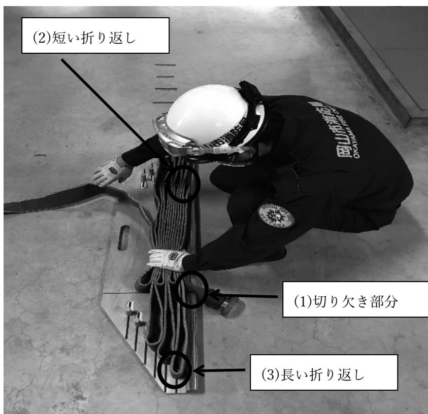
図 12 木製バリアブルジグによる「S. U. S式」作成の様子。作成時間約 30 秒
