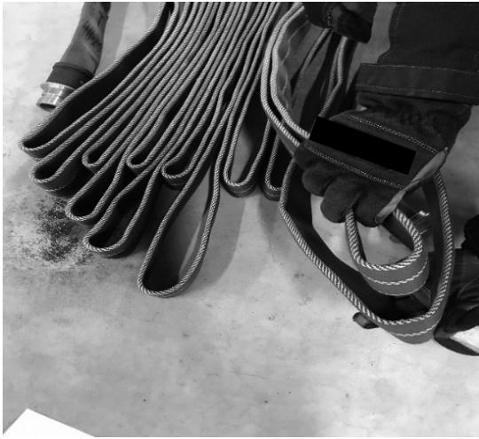
図3 長い折り返し部分又は短い折り返し部分をメス金具側から順番に取り内側に重ね、最後はオス金具のはかま付近も一緒に重ねる。
