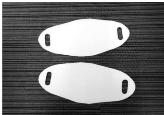
写真8 ボード (超高分子量ポリエチレン)
