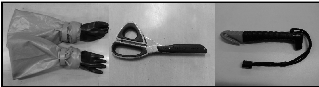
写真3 陽圧式化学防護服の前腕部分を着装し、切断完了までの時間を計測
