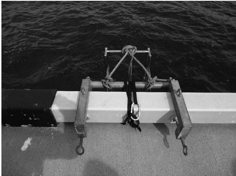
写真 4-2 設置テスト時アタッチメント取り付け状況
