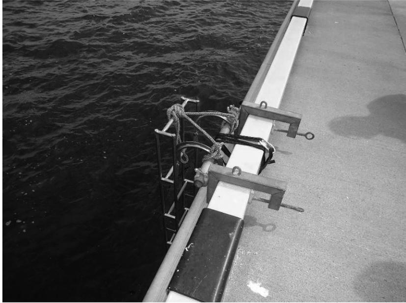
写真 4-1 設置テスト時アタッチメント取り付け状況
