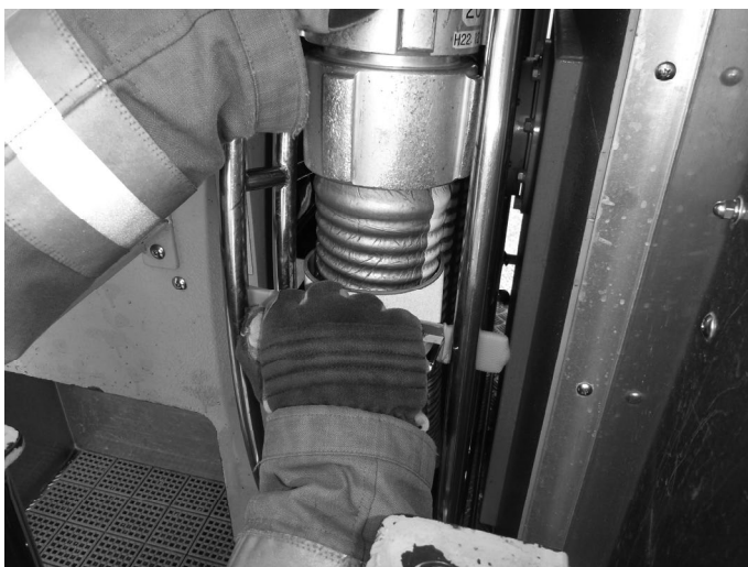
【写真 12～14】 開発品を巻き取り装置から取外している様子 (運転席側)
