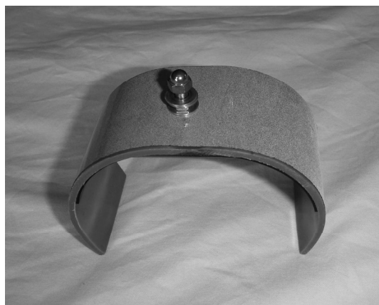
【写真11】 吸管受け部（外側）
