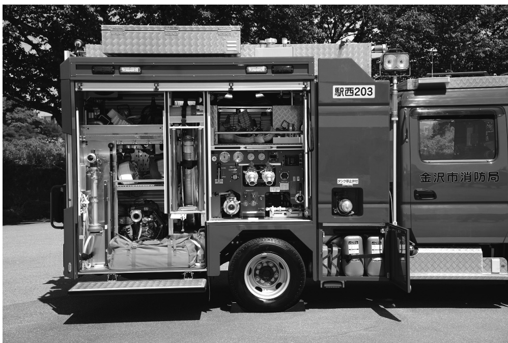
【写真2】 双方向引き吸管巻き取り装置を搭載した車両の資機材収納スペースの様子
