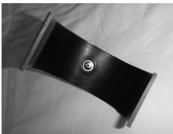
【写真10】 吸管受け部（内側）
