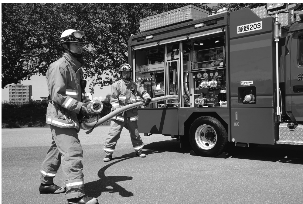
【写真2】 双方向引き吸管巻き取り装置を搭載した車両の資機材収納スペースの様子
